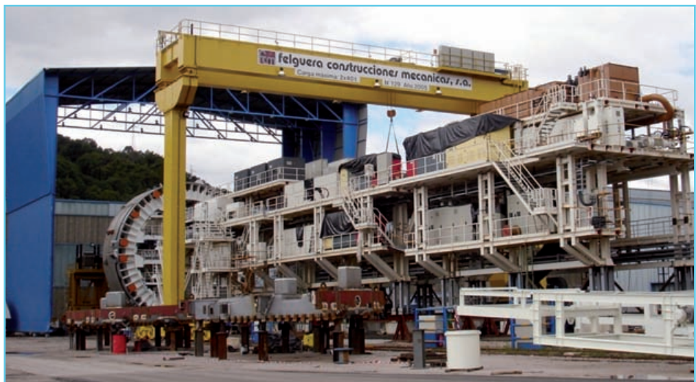
Foto 2. Tuneladora Mitsubishi en la factoría Duro Felguera en fase de pruebas.
