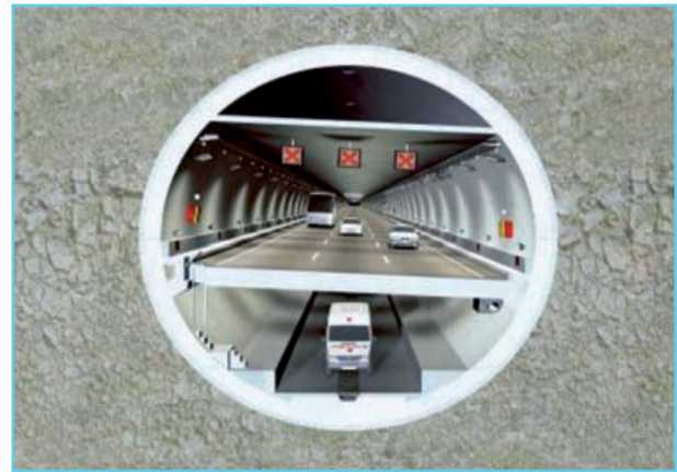
Figura 2. Sección transversal del túnel, con sistema de ventilación, calzada de circulación y galería de emergencia.
