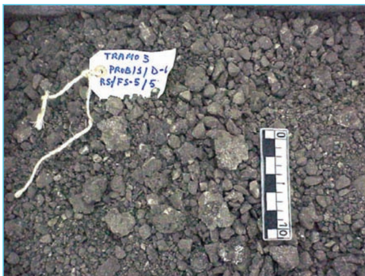
Foto 2. Ejemplo de material procedente de un fresado en España obtenido en uno de los ensayos del proyecto SCORE
