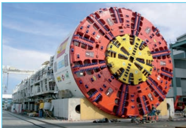
Foto 1. Vista de la rueda de corte, con la doble cabeza de corte, una exterior y otra interior.
