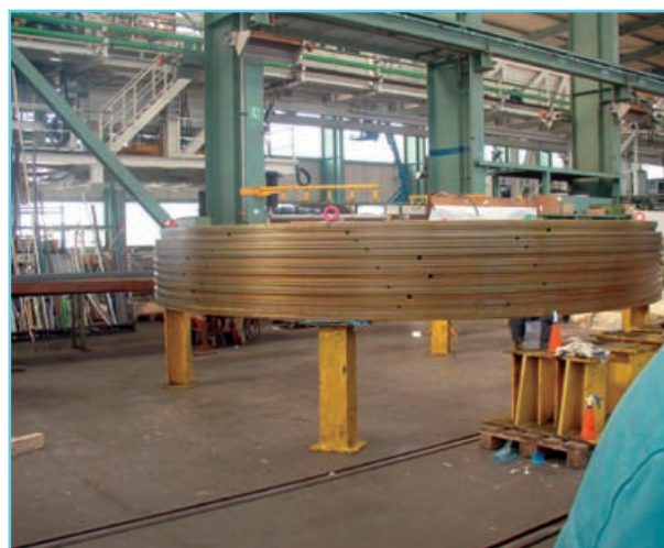
Foto 6. Paso giratorio, donde se disponen los conductos de agua, espumas o polímeros.
