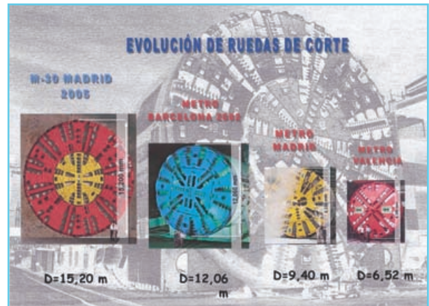
Figura 4. Evolución del diámetro de las ruedas de corte.
