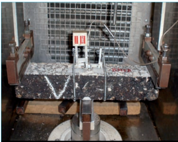
Foto 2. Ensayo de flexotracción dinámica con 3 puntos de apoyo
